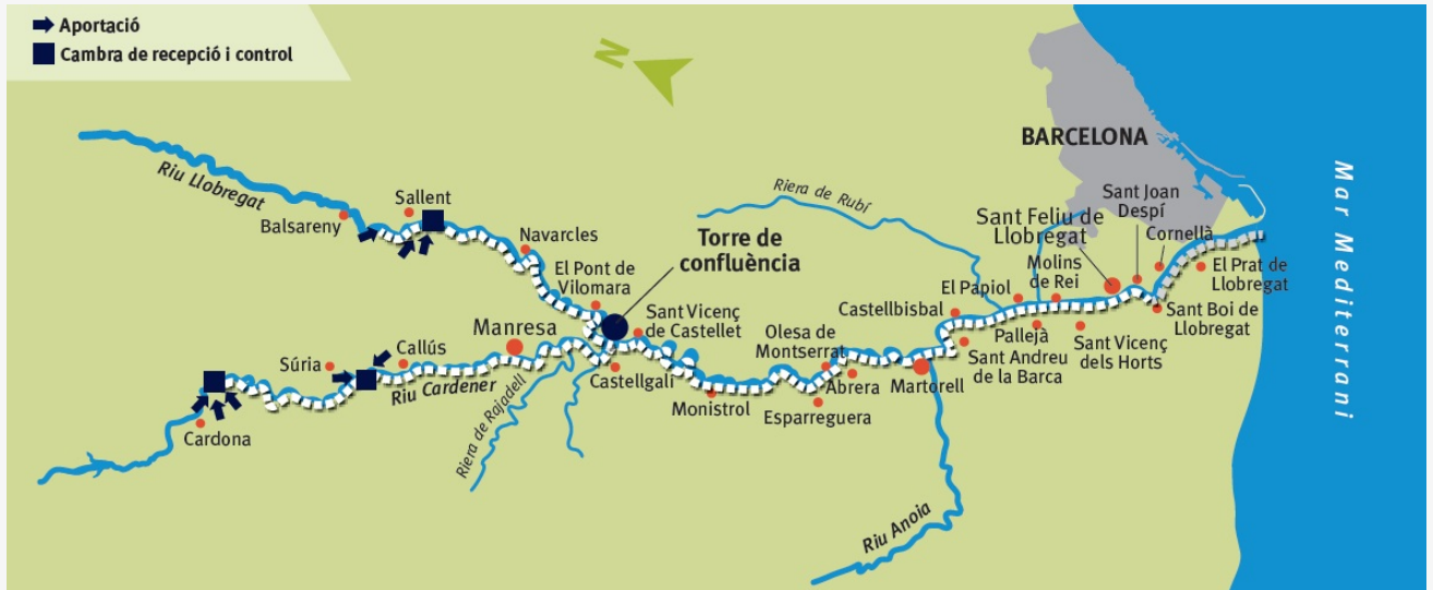
Figura 5. Esquema con la traza del colector de salmuera Fuente: "https://sostenibilitatimineria.files.wordpress.com/2016/04/colector-de-sal-morres-aca.jpg"
