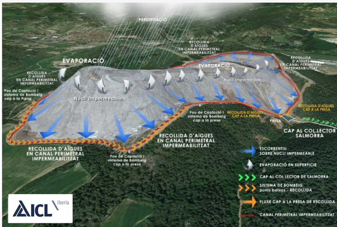
Figura 6. Esquema de las principales medidas preventivas y correctivas implantadas en la gestión del agua en los depósitos salinos. Fuente: ICL Iberia
